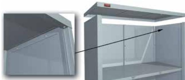
9. Установить перегородки. Установку перегородок рекомендуется начинать с самой верхней. Верхние перегородки отличаются от нижних наличием на верхней отбортовке двух прямоугольных отверстий. Верхнюю перегородку завести верхней отбортовкой под фиксирующую полосу крыши и задвинуть до защелкивания замков. Затем соединить верхнюю перегородку с нижней с помощью двух винтов M5x10 с гайками (сквозь отверстия в полке). Самую нижнюю перегородку соединить с дном с помощью двух саморезов.
