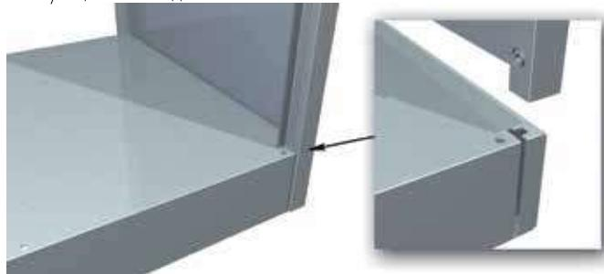
2. Прикрепить боковую стенку к дну двумя саморезами. Для облегчения сборки рекомендуется лишь слегка "наживить" саморезы, не затягивая до конца (либо вообще не устанавливать), а окончательную затяжку производить после выполнения пункта 4 настоящей инструкции .
