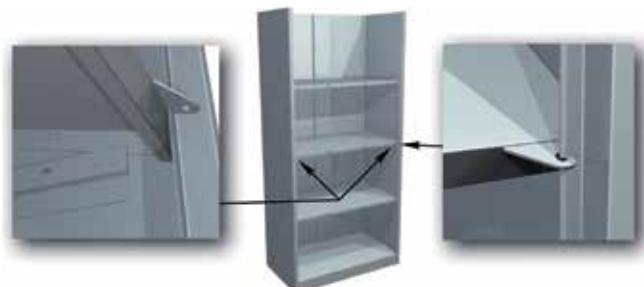
8. Установить крышу . При установке крыши боковые и задние стенки должны располагаться между внутренними боковыми поверхностями крыши и угловыми профилями. Крышу опустить вниз до защелкивания замков боковых стенок в отверстиях угловых профилей крыши.
