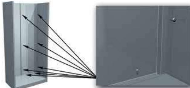
7. Установить полки. Установку рекомендуется начинать с нижней полки. Для установки полки следует завести ее в пространство между боковинами, повернуть вокруг продольной оси и завести таким образом, чтобы выступающий кронштейн оказался в прорези правой боковой стенки, а боковые отбортовки полки попали под фиксирующие полосы на боковых стенках. После этого опустить полку вниз до защелкивания замков фиксирующих полос в отверстиях полки.
