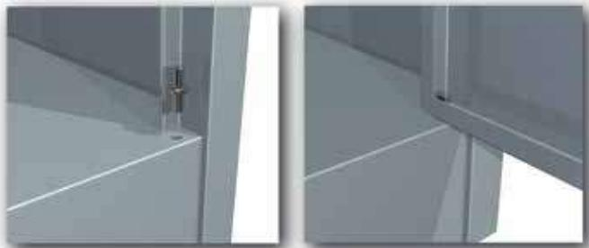
11. На верхнюю плоскость двери положить шайбу. Удерживая шайбу, верхнюю плоскость двери завести под кронштейн полки. Совместив соответствующие отверстия в двери и кронштейне, вставить ось . Аналогичным образом установить двери второго и третьего яруса.
