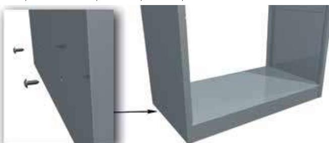
4. Положить изделие на горизонтальную поверхность передней частью вниз. Соединить боковые стенки с дном с помощью четырех винтов M5x16. После этого вернуть изделие в вертикальное положение.
