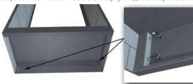
5. Установить левую заднюю стенку, соединив ее с левой боковой стенкой с помощью трех саморезов и с дном – с помощью двух саморезов.
