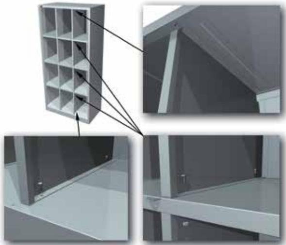
10. Установить двери в следующей последовательности. В отверстие dna вставить ось. Надеть дверь нижним отверстием на ось.
